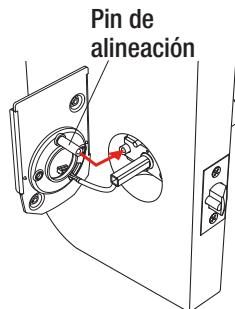
D. Inserte dos tornillos de la placa de montaje (BB) a través de los orificios en la placa y encájelos en los orificios del ensamble exterior. Apriete firmemente. Revise para asegurarse que el conjunto exterior no se vea torcido con respecto a la puerta.
