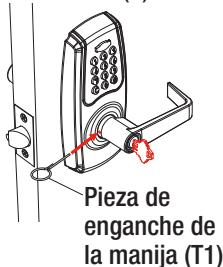
C. Cuidadosamente retire el ensamblaje de la manija exterior mientras remueve la pieza de enganche de la manija. El ensamblaje puede ser remplazado luego de acuerdo a las instrucciones en el Paso 6. Para cambiar el sentido el sentido continúe al paso D.
