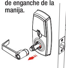
J. Presione el botón SWITCH para colocar el eje interior en posición neutral.
