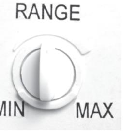
Repérer les deux commandes au fond du capteur. La commande RANGE (sensibilité du capteur) est située au fond, à gauche. L'interrupteur ON-TIME (durée d'éclairage) est situé au fond et au centre.
